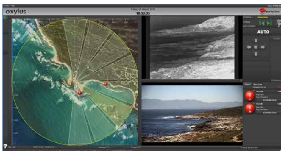
Oxylus Software zeigt die Karte mit den gescannten Bereichen; Bild einer Tag/Nacht- sowie Wärmebildkamera und ausgelösten Alarmen
